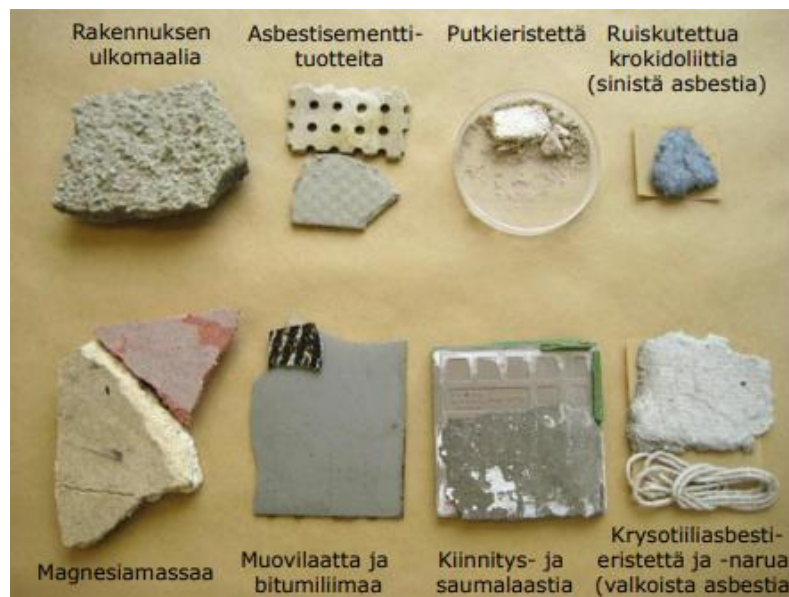
Kuva 1. Erilaisia, asbestia sisältäviä rakennusmateriaaleja [20.]
