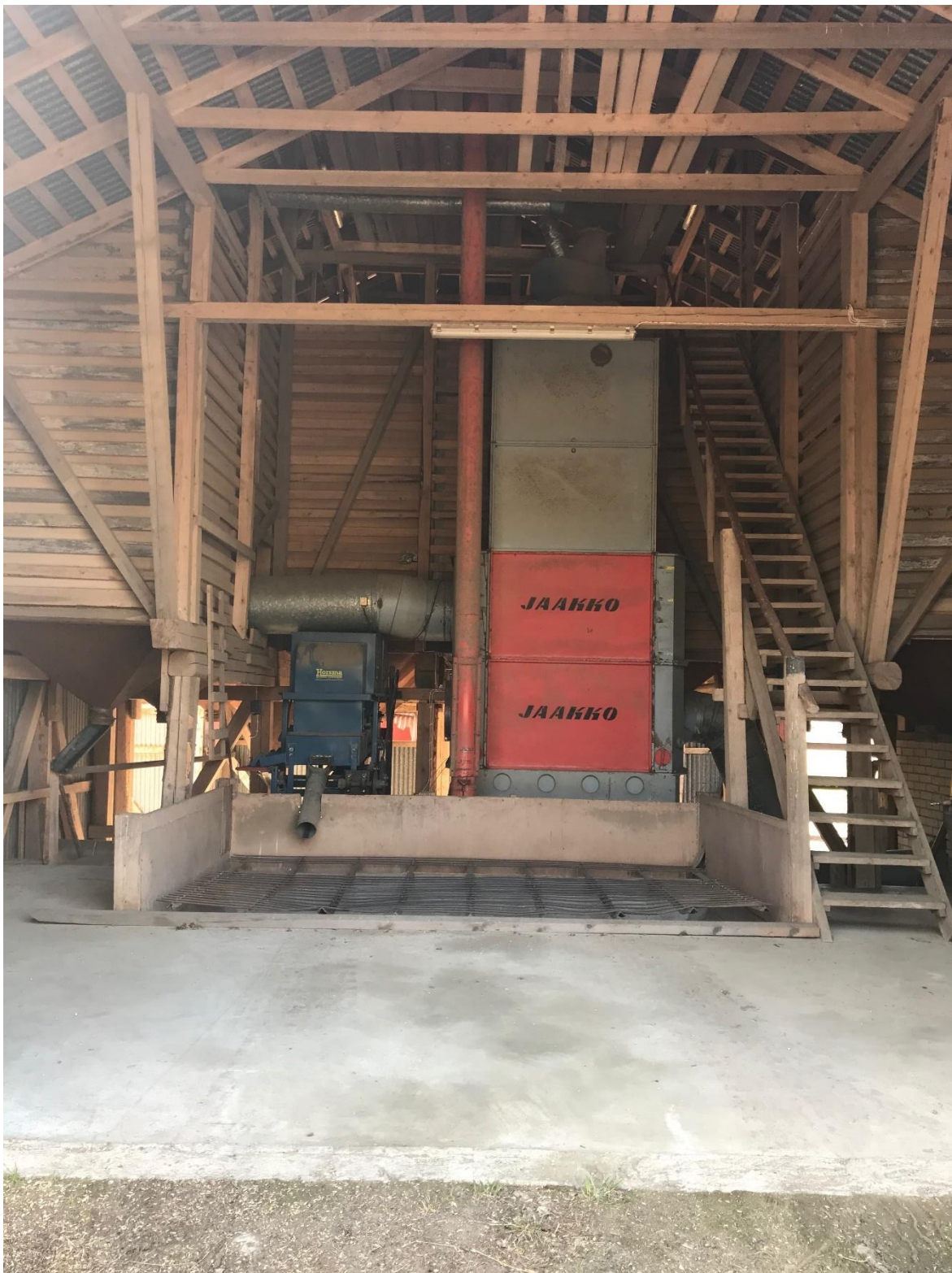
Kuva 14. Kuva kuivurista. Kuivurissa tuotteet kuivattaa Jaakko lämminilmakuivuri ja kuivurista löytyy myös viljan lajittelija
